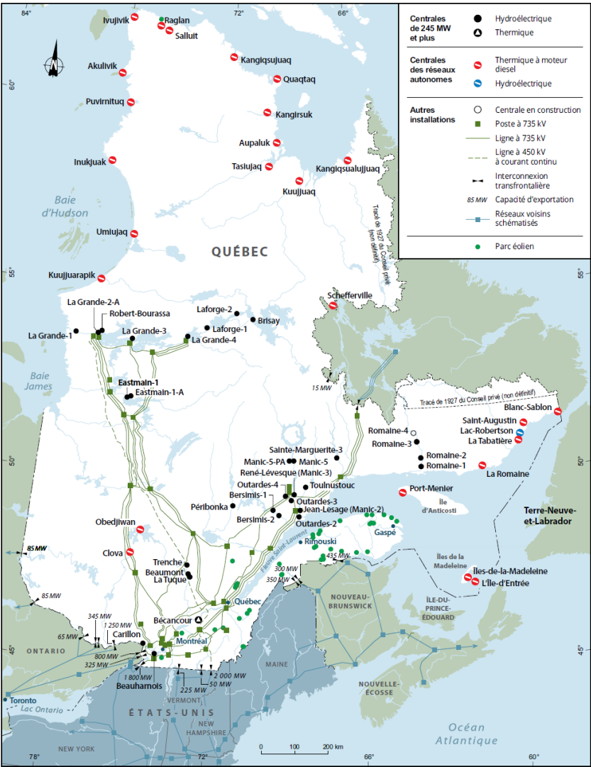
GRAPHIQUE 14 • CARTE DES PRINCIPAUX ÉQUIPEMENTS DE PRODUCTION ET DE DISTRIBUTION D'ÉLECTRICITÉ AU QUÉBEC, 2020
